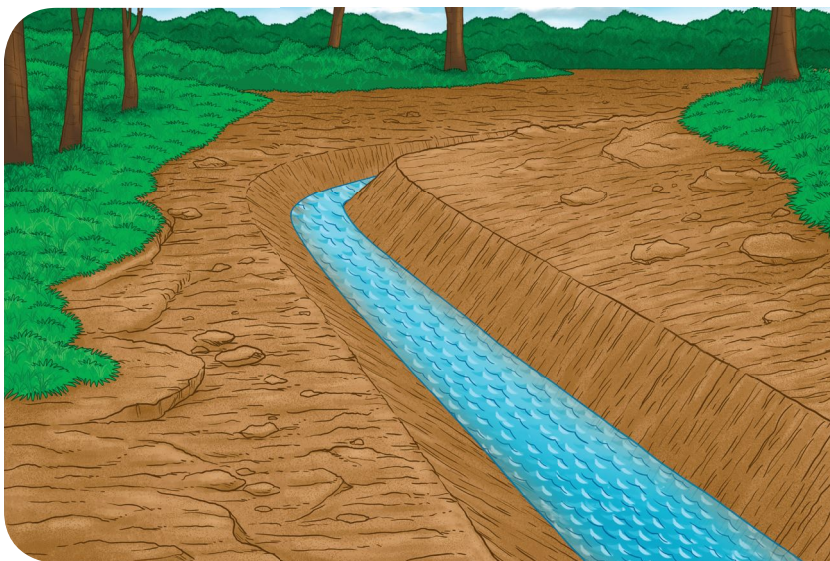
Canal escavado em formato trapezoidal, sem revestimento
