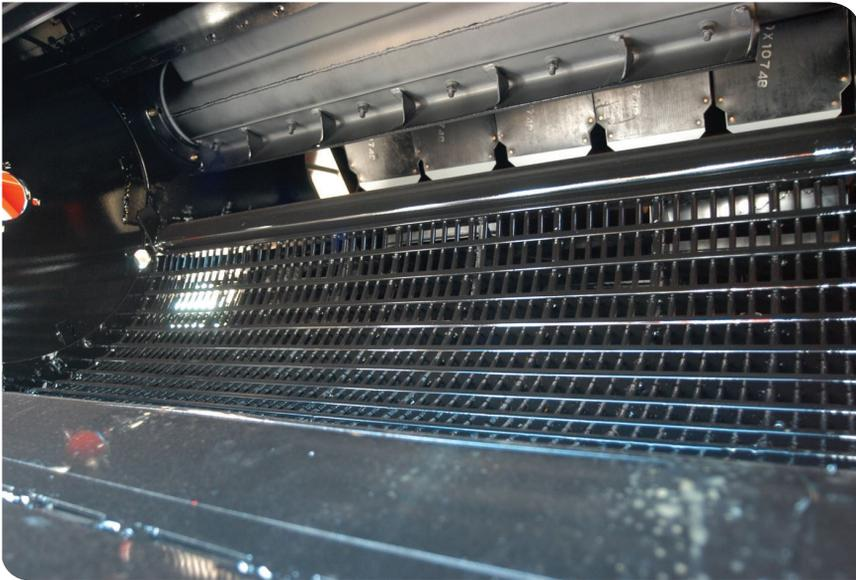
É uma estrutura ajustável, localizada abaixo do cilindro de trilha, formada por chapas perfuradas curvas ou por barras que auxiliam a trilha dos produtos. Dependendo do produto a ser trilhado, o côncavo poderá ser ajustado para obtenção de uma trilha mais eficiente.
