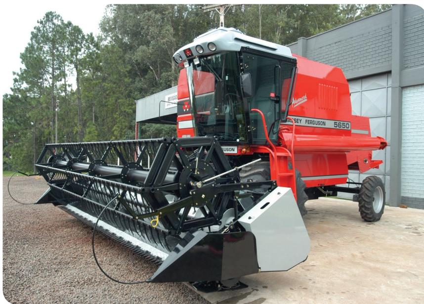
As máquinas colhedoras são capazes de fazer o corte, a trilha ou debulha, a separação e a limpeza dos grãos antes de despejá-los nos caminhões.
