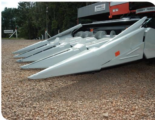
A altura dos bicos deverá ser igual para todos, de modo que a superfície inferior dos bicos fique paralela em relação ao solo.
