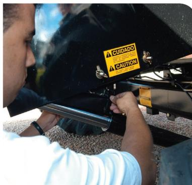
4.3 - Ajuste a posição do bico separador esquerdo posicionando os elos da corrente de modo a obter o ângulo desejado
