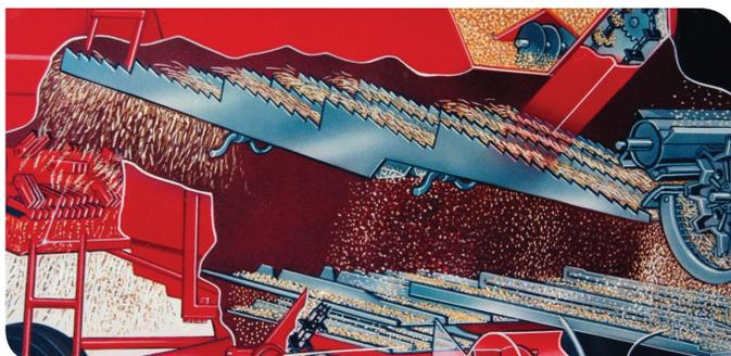
*Mecanismo de separação de palha*
