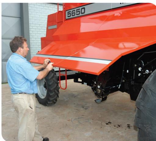
1.2 - Solte a trava que fixa a alavanca de regulagem de vazão do ventilador
