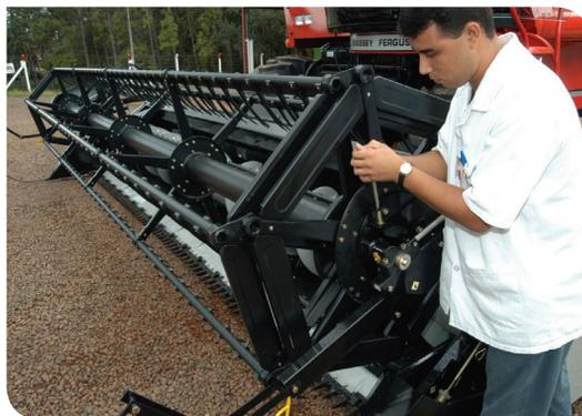
**2.3.2 - Mova a alavanca, para frente ou para trás, para ajustar a inclinação das hastes**
