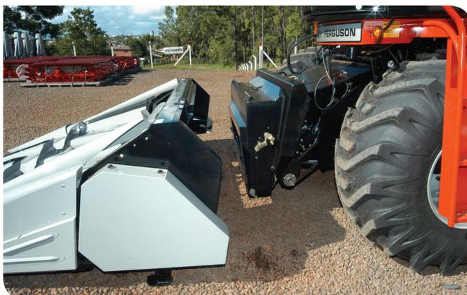
2.2 - Acione os hidráulicos da plataforma para levantá-la
