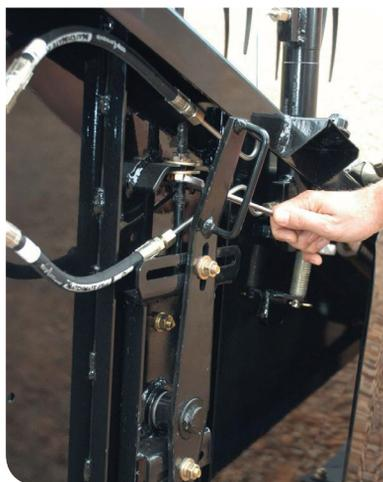
**3.2.3 - Ajuste a altura do caracol atuando na porca do parafuso tensor, nos dois lados da plataforma**
