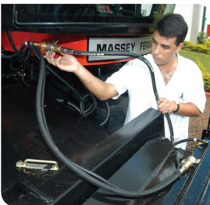
1.4 - Acople a mangueira de acionamento da rotação do molinete no engate rápido da colhedora
