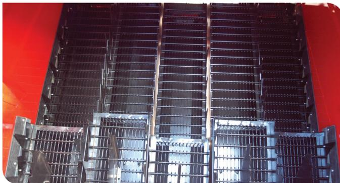
O mecanismo de separação, denominado de saca-palhas, é usado para separar os grãos debulhados das palhas ou aqueles que não foram separados no côncavo durante a trilha.
