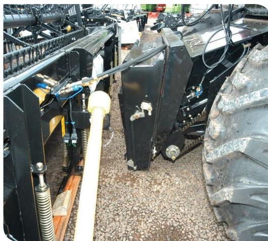
1.2 - Acione os hidráulicos da plataforma para levantá-la
