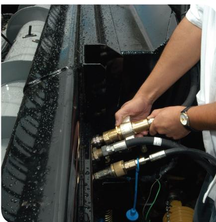
1.5 - Acople a mangueira de acionamento do molinete da colhedora no engate rápido da plataforma
