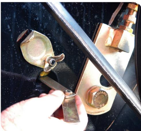
4.2 - Atue nos parafusos de ajuste do côncavo instalados nos dois lados da máquina
