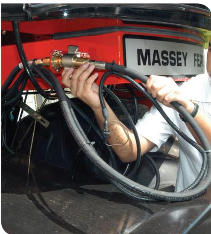
1.3 - Desconecte os engates rápidos das mangueiras hidráulicas de acionamento da plataforma
