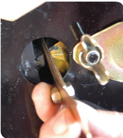
4.3 - Meça a folga entre o côncavo e o cilindro de trilha usando a escala de referência ou gabarito para ajuste da folga
