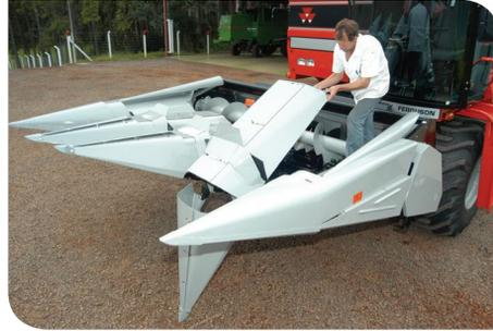
2.7 - Aperte ou afrouxe o parafuso de ajuste para obter uma abertura de 33 mm na parte da frente
