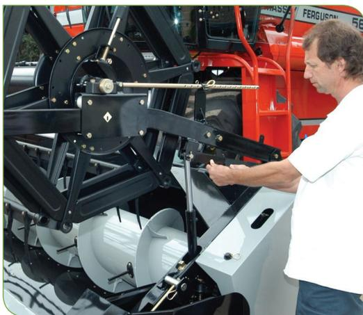
**2.1.2 - Libere a trava de segurança do cilindro hidráulico de levantamento do molinete**
