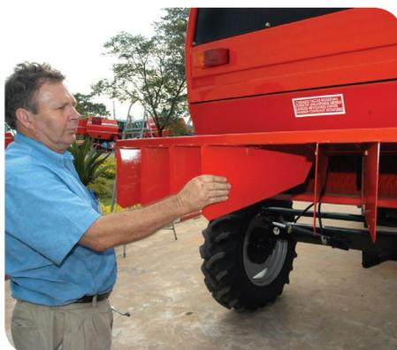
2.3 - Reaperte os parafusos de fixação de cada aleta do espalhador
