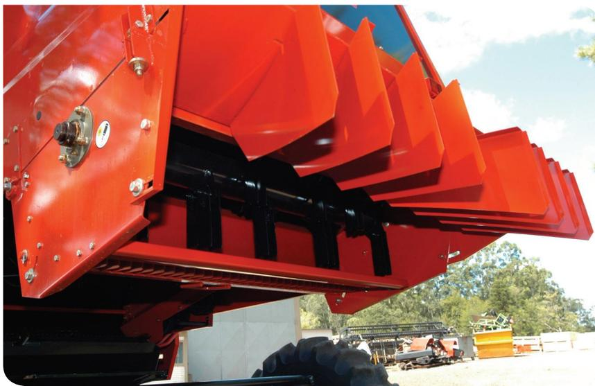
O picador de palha é utilizado para picar ou fragmentar a palhada que sai do mecanismo de separação, antes de lançá-lo ao solo, atrás da máquina. A picagem permite uma melhor incorporação e degradação desse material, além de facilitar o plantio após a colheita.
