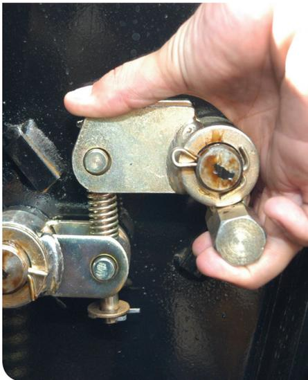
1.9 - Acople o eixo cardam para o acionamento da plataforma
