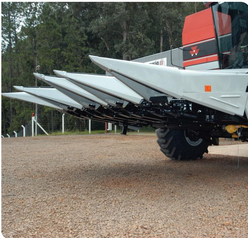
1.2 - Trave a plataforma na posição elevada, utilizando o dispositivo de segurança do cilindro hidráulico da plataforma
