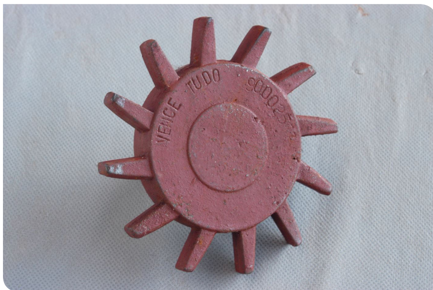
Engrenagem rotativa autolimpante
