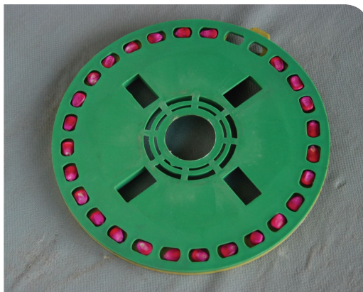
Disco para milho furo oblongo com a semente
