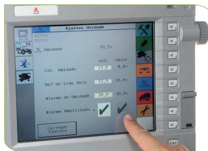
Além das informações da umidade real e da umidade informada pelo sensor da colhedora, é necessário que o operador estabeleça o nível de umidade máxima e de grão seco (mínima).
