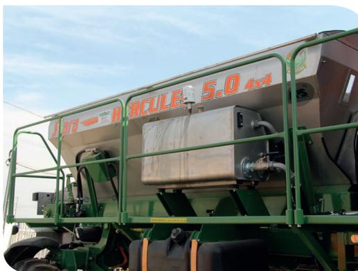
Em distribuidores que fazem aplicação por discos giratórios, a faixa de aplicação é medida observando a sobreposição de uma passada sobre a outra, procurando deixar a deposição o mais homogênea possível.
