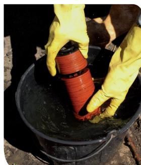
9.5 - Recoloque e encaixe os discos dentro da cápsula
