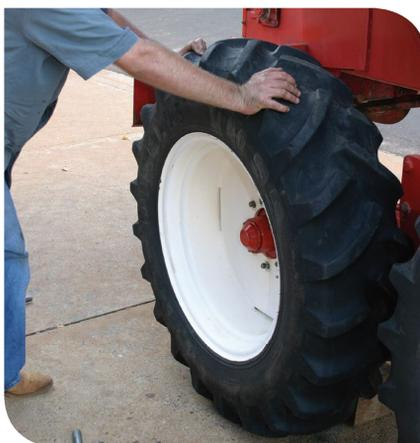
**b) Coloque os parafusos**
