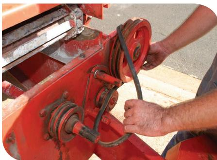
1.7 - Retire os anéis de fixação das polias
