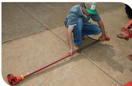
b) Coloque a graxa ao longo da barra interna do cardã
