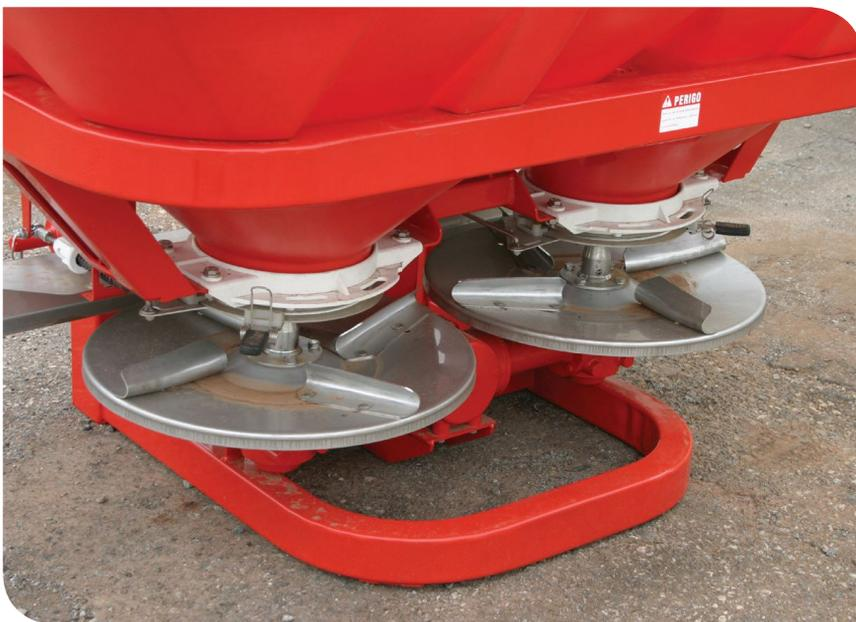
Neste tipo de máquina, o dispositivo central funciona como um defletor, e a disposição radial das paletas nos discos influi sobre a forma de lançamento das partículas, melhorando a uniformidade de distribuição e a largura da faixa aplicada, independentemente da dosagem de aplicação.
