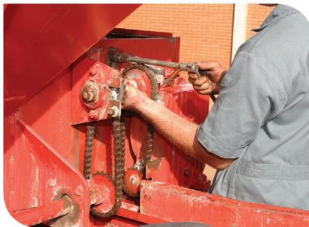
2.10 - Aperte os parafusos do mecanismo tensor
