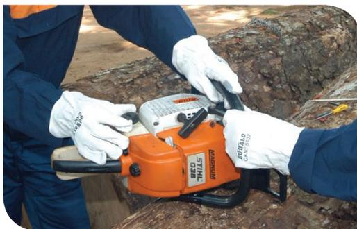
4.6 - Limpe a tampa do tanque após o abastecimento
