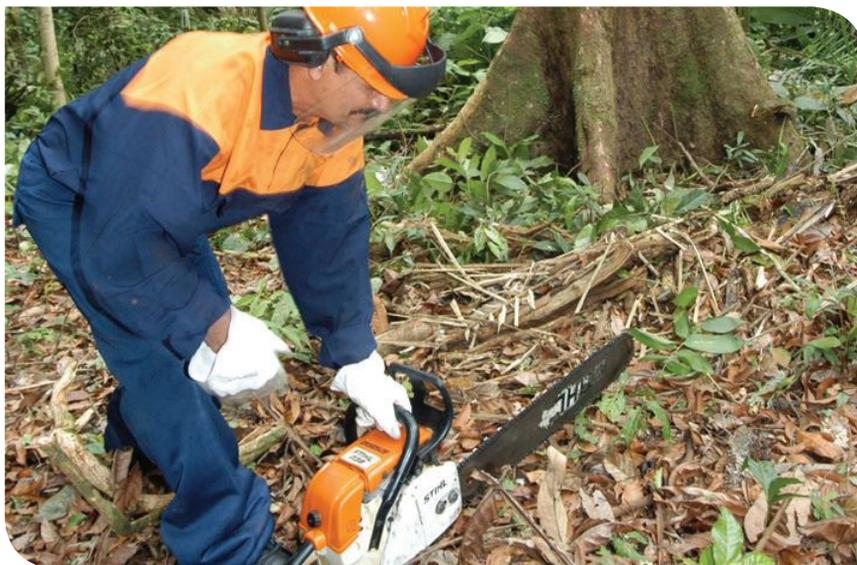
Para fazer funcionar a motosserra deve-se seguir os passos detalhados anteriormente, tendo o cuidado de a máquina estar, pelo menos, a 3 m do local de abastecimento, ou onde se encontra o recipiente com a mistura de combustível.
