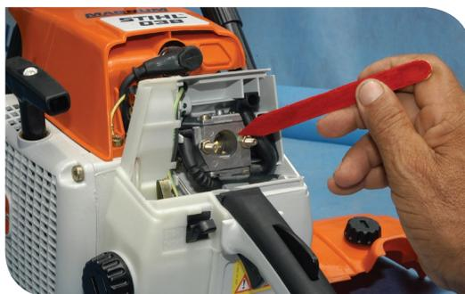
**e) Parafusos fixadores da carcaça do carburador**
