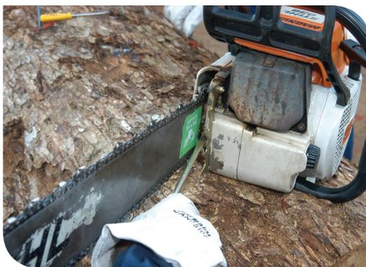
levantar a corrente na parte superior, mais ou menos na metade do comprimento do sabre, e verificar que 3 ou 4 guias dos dentes da corrente ultrapassem levemente a superfície superior do sabre.
