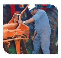
12.4.5 - Coloque o contrapino no pino de acoplamento inferior direito do arado
