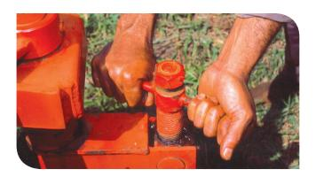
Isto é feito girando o parafuso no sentido dos ponteiros do relógio, para diminuir a profundidade de aração
