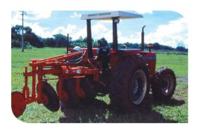
5.2 - Coloque os discos paralelos ao trator, acionando o controle remoto de reversão dos discos
