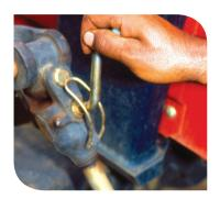
12.4.3 - Retire a trava do pino de acoplamento inferior direito do arado
