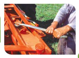
5.4 - Ajuste a posição do cursor para alterar a largura de corte
