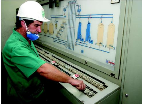
**7** LIGUE O SISTEMA DE TRANSPORTE PARA ABASTECER A PRÉ-LIMPEZA
