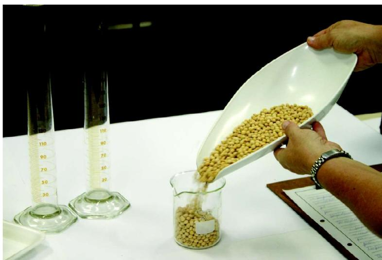
**3 COLOQUE OS GRÃOS DE SOJA NA PROVETA ATÉ ATINGIR A MARCA GRADUADA DE 100 mL DE VOLUME**
