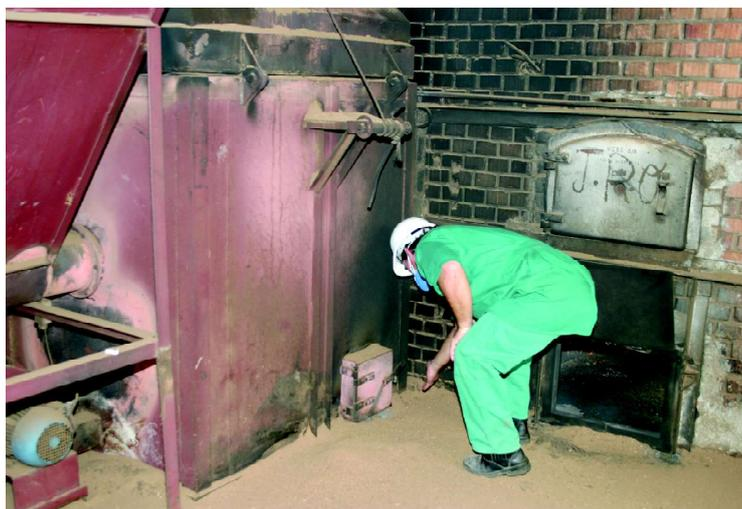
*Atenção: O alcatrão, formado pela queima da lenha, pode se sedimentar no interior do secador, por isso precisa ser retirado periodicamente para evitar incêndios.*
