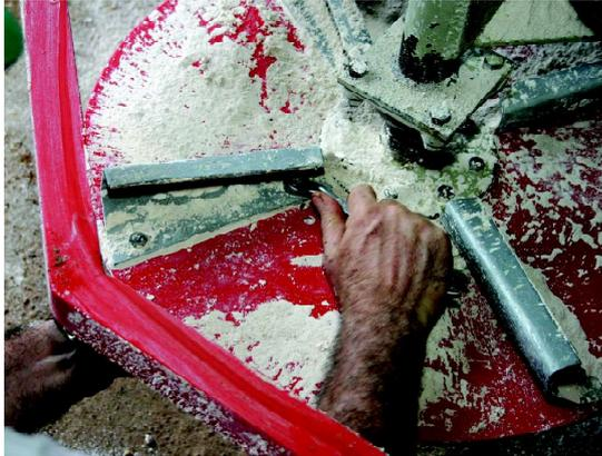
**2.2 SOLTE O PARAFUSO DE REGULAGEM DA PALHETA, QUE SE LOCALIZA PRÓXIMO AO CENTRO DO DISCO**
