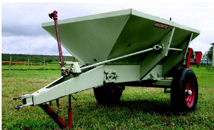
O distribuidor é chamado de arrasto quando é puxado pela barra de tração do trator, e, de montado, quando é acoplado ao seu sistema hidráulico de três pontos.
