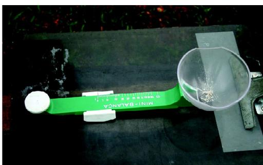
1.11.2 COLOQUE A BALANÇA EM LOCAL NIVELADO E LISO
