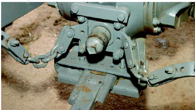
A TDP possui uma proteção para evitar que fique impregnada de sujeira, o que dificultaria o seu acoplamento.
