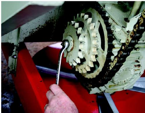
e) Retire as rodas dentadas da corrente do eixo conduzido
