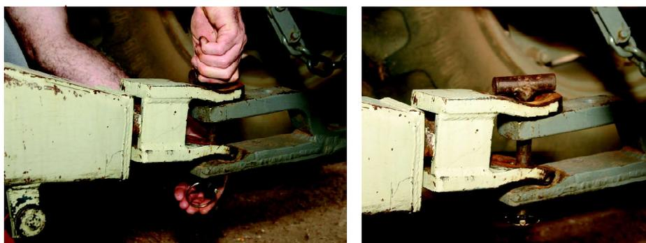
*Precaução:* O operador deve prestar bastante atenção e verificar se o pino está travado, para evitar que ele se solte durante a operação, causando acidentes graves.
