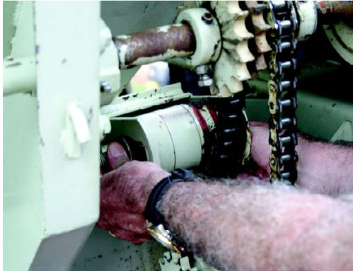
d) Solte o parafuso que fixa o conjunto de rodas dentadas conduzidas
