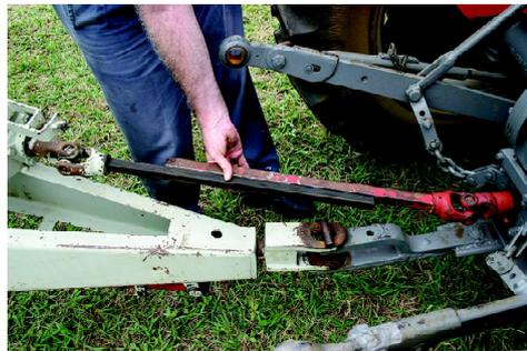
b) Posicione a barra e o tubo do eixo cardã lado a lado
