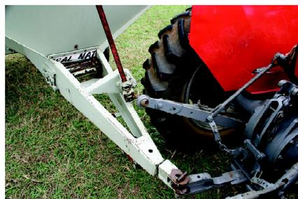
*Atenção: Outros modelos de distribuidor podem produzir maior encurtamento no eixo cardã do lado direito, por isso é necessário fazer essa verificação se o modelo utilizado for diferente.*
