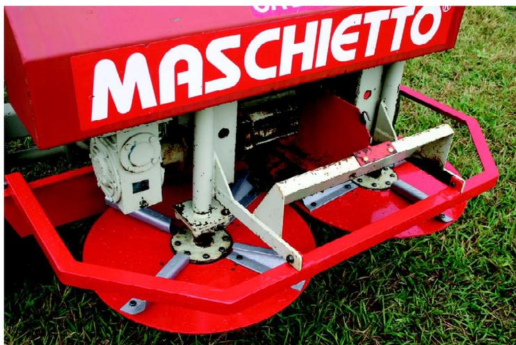
Os distribuidores podem ser arrastados pela barra de tração do trator ou acoplados em seu sistema de engate de três pontos.
