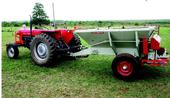
*Atenção: O distribuidor deve ser pulverizado com óleo antiferrugem para dar proteção, principalmente, às partes móveis.*
