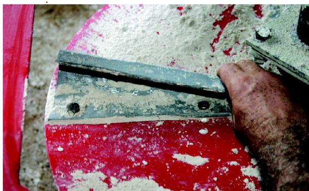
*Atenção: Quando o distribuidor é de duplo disco, a regulagem das palhetas deve ser igual para os dois discos, a fim de garantir a uniformidade de distribuição.*
