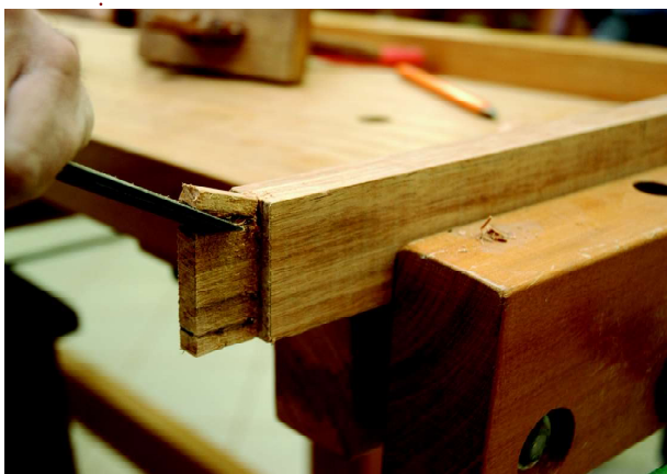
8.15 RETIRE O PEDAÇO COM O FORMÃO RETO ATÉ A MARCA DEFINIDA
