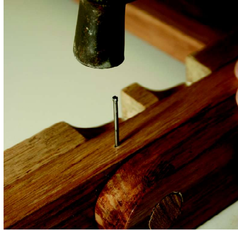
18.9 FIXE UM PREGO NA CAVILHA PELA LATERAL DO ENCOSTO
