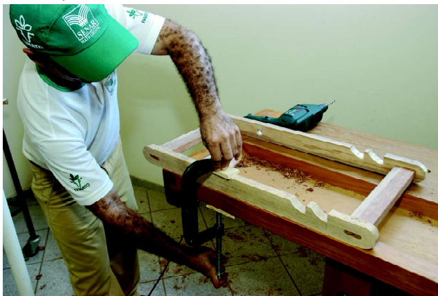
15.6 PRENDA A BASE COM UM GRAMPO NA BANCADA
