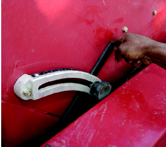
Alavanca de regulagem da abertura da comporta
