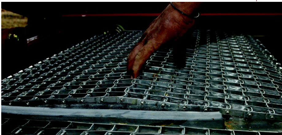
Esteira com tensão adequada
