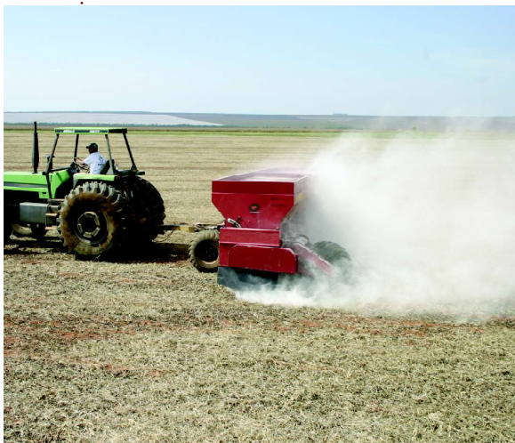
Deriva excessiva causada pelo vento
