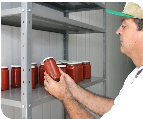
O armazenamento do produto final deverá estar isolado das outras etapas. Caso o local de armazenamento seja na mesma construção das demais etapas de produção, deverá ser isolado por paredes de alvenaria comum e com uma porta de acesso, para prevenir a contaminação do produto final.
