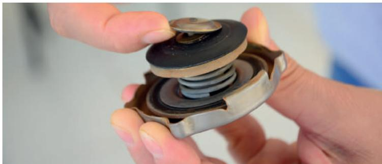
**PRECAUÇÃO:** espere o líquido esfriar antes de abrir a tampa. Se abri-la com o líquido muito quente e com a pressão existente no sistema poderá sofrer queimaduras. Após esfriar, gire a tampa até a primeira posição ou  $\frac{1}{4}$  de volta para deixar escapar o vapor e a pressão remanescente e só depois remova a tampa.
