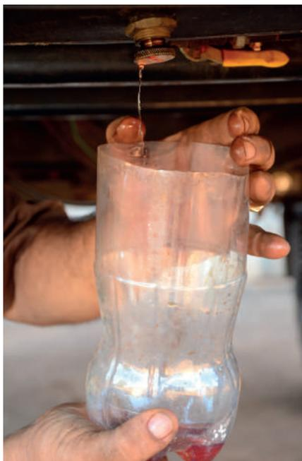
**5.2.2** Retire o filtro de tela do bujão de dreno e limpe-o com óleo diesel. Monte o filtro na ordem inversa da desmontagem e verifique se não há vazamentos
