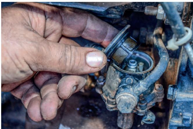
**5.4.1.3** Lave com óleo diesel ou sopra com ar comprimido.
