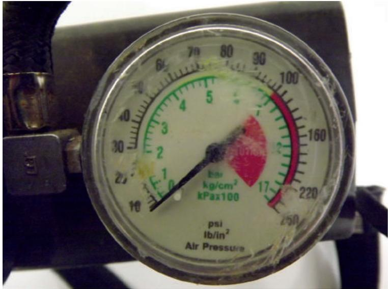
**ATENÇÃO 1: Pressão máxima do compressor: 70 lbf/pol<sup>2</sup> ou 4.8 Bar.**
