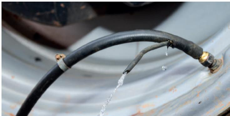
Em pneus de construção diagonal (convencional), a quantidade de água máxima a ser colocada é de aproximadamente 75% do volume.
