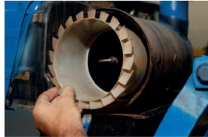
A eliminação das partículas mais pesadas pode ser realizada por um ejetor através dos gases do escapamento ou ainda em outros modelos, por sucção da hélice do sistema de arrefecimento.
