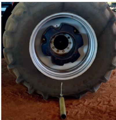
**2.3** Com a tração dianteira desligada, percorra 10 voltas do pneu traseiro e anote o número de voltas dadas pelo pneu dianteiro.
