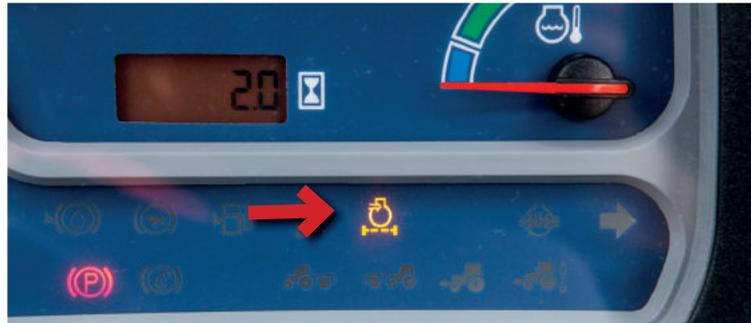
Para testar o funcionamento do sensor do indicador de restrição do filtro de ar, funcione o motor em rotação mediana e, com auxílio de outra pessoa, obstrua parcialmente a entrada do ar.
