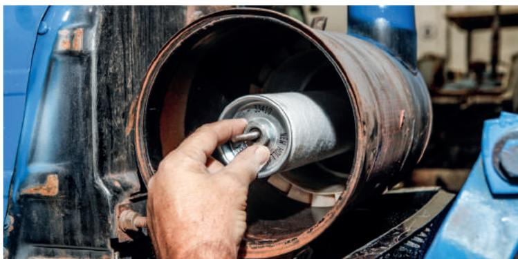
**ATENÇÃO:** Inspeccione periodicamente as borrachas de vedação, mangueiras e abraçadeiras do sistema de alimentação, evitando a entrada de poeira.
