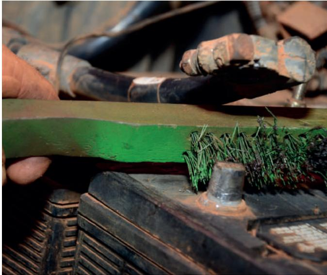
A limpeza dos terminais dos cabos da bateria deve ser feita quando necessário; para isto, desconecte os cabos, sendo primeiro o negativo e depois o positivo.
