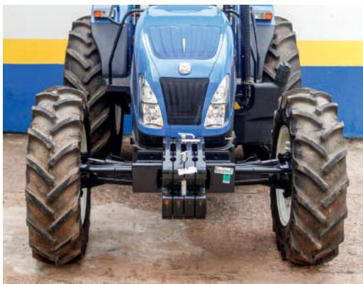
**6.2** Meça a distância entre as bordas dos aros na parte dianteira do pneu, à altura da ponta de eixo
