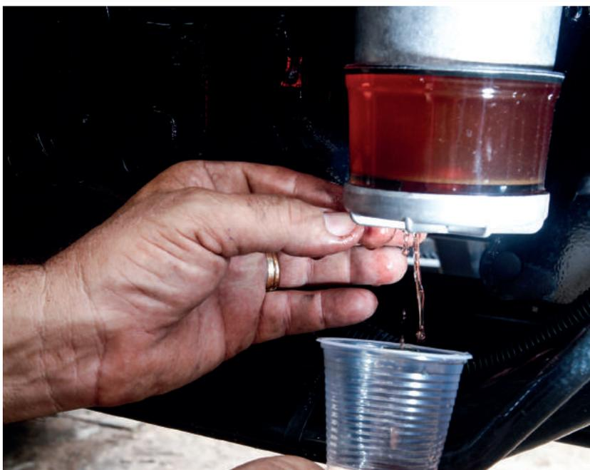
**5.3.1** No momento da substituição do (s) filtro (s) de combustível, faça a limpeza do sedimentador, seguindo os procedimentos da seguinte forma:
