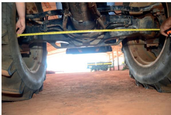
A convergência é a diferença entre a extensão traseira e a dianteira das rodas. Consulte o manual do trator para fazer a correção através de regulagens nos braços da direção.
