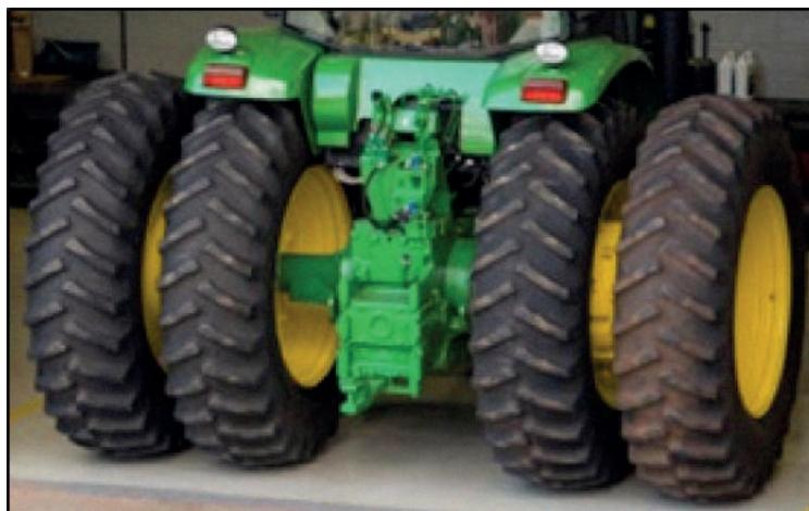
**ATENÇÃO:** Reaperte periodicamente as porcas e parafusos das rodas com o torque especificado e nos intervalos recomendados no manual do trator.
