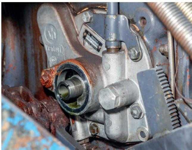
Monte o filtro novo, aplicando uma camada de óleo limpo no anel de vedação de enrosque-o em sua sede com as mãos.
