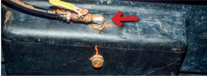
**5.3.1.2** Remova os componentes do filtro sedimentador.
