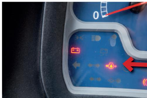
**ATENÇÃO:** caso a luz indicadora de baixa pressão de lubrificação do motor acenda ou o mostrador indique baixa pressão, pare imediatamente o trator e desligue o motor para verificações.
