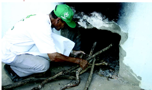
13.1.1 COLOQUE A LENHA NA FORNALHA
