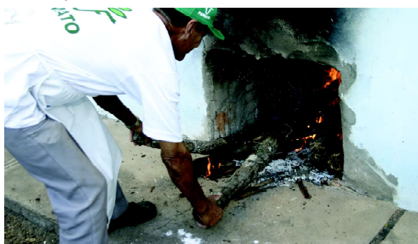
13.1.3 EMPURRE A LENHA PARA O INTERIOR DA FORNALHA
