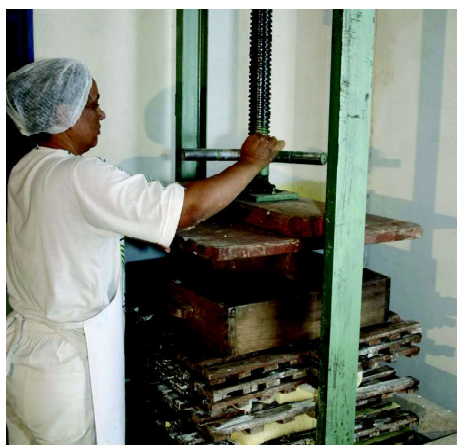
2.11 RODE OS EIXOS COM AS MÃOS PARA PRENSAR
