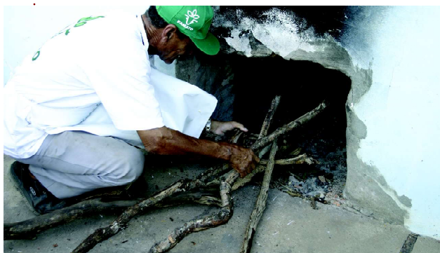
7.1.1 COLOQUE A LENHA NA FORNALHA
