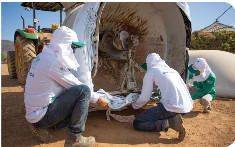
As máquinas de enchimento mais usadas são as acopladas à tomada de potência (TDP) do trator, conduzindo e forçando o grão para o interior da lona.
