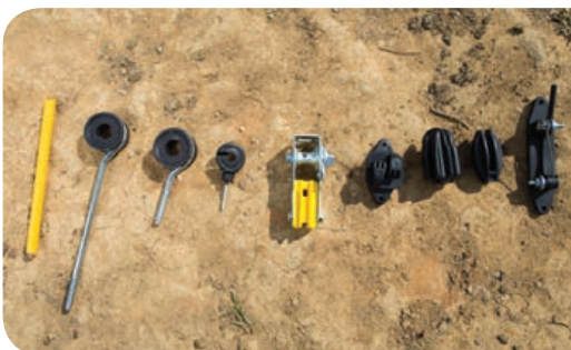
tubo isolado, isoladores e chave interruptora
