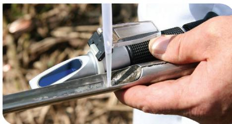
**c)** Coloque as gotas sobre o refratômetro
