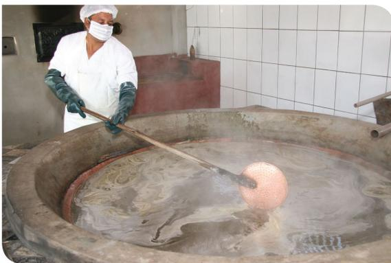
**Segunda:** é a área que fica no interior da construção, onde se faz o processamento do caldo para a obtenção da rapadura e do açúcar mascavo.
