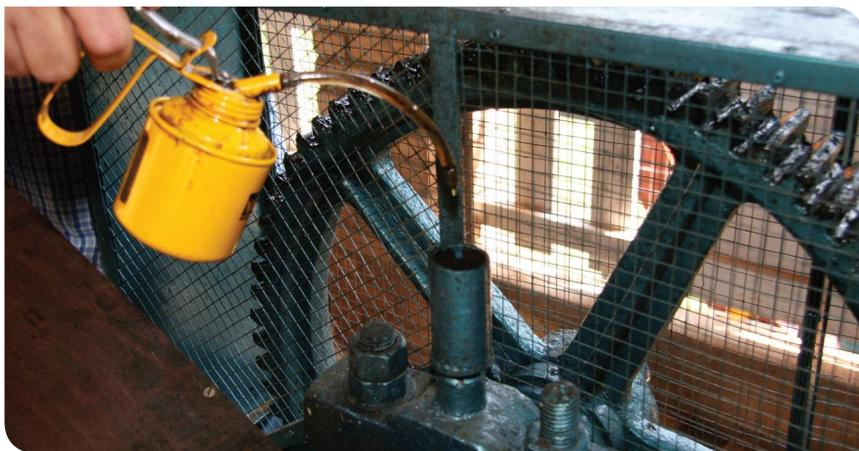
O lubrificante diminui o atrito das engrenagens e mancais e favorece o rendimento da máquina. No entanto, ao lubrificar máquinas que se destinam a fabricação de produtos da indústria alimentícia, deve-se ter o cuidado de direcionar a manutenção aos locais apropriados, que apresentam proteção contra o vazamento, a fim de evitar o contato do lubrificante com o produto.
