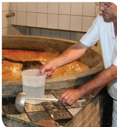
3.2 - Despeje um pouco do caldo na água com auxílio de uma concha
