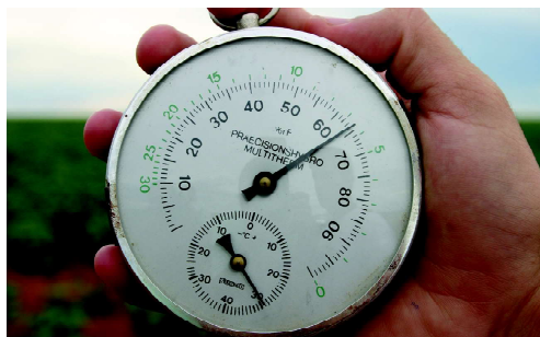
Temperatura (°C) e umidade (%)
