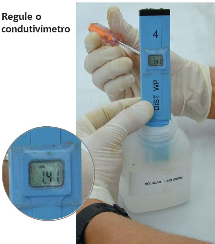
Esta calibragem é feita introduzindo o condutímetro em solução tampão de calibragem e regulando a 1,41 mS/cm.
