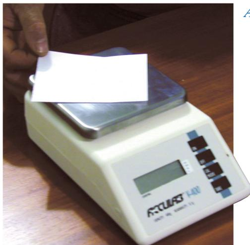
**Atenção:** A colocação do papel sobre o prato da balança é importante para evitar que os sais pesados corroam as partes metálicas estragando a balança.
