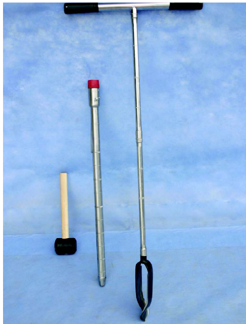
Sonda e trado para amostragem de solo
