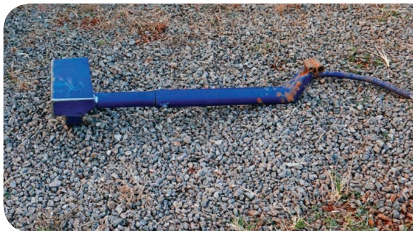
Barra utilizada em pulverizador tratorizado para aplicação de drench
