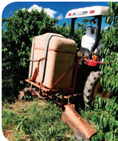
Proteção antideriva nas barras de aplicação de equipamento tratorizado
