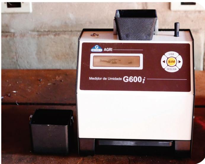
Modelo de medidor utilizado no controle de umidade das sementes
